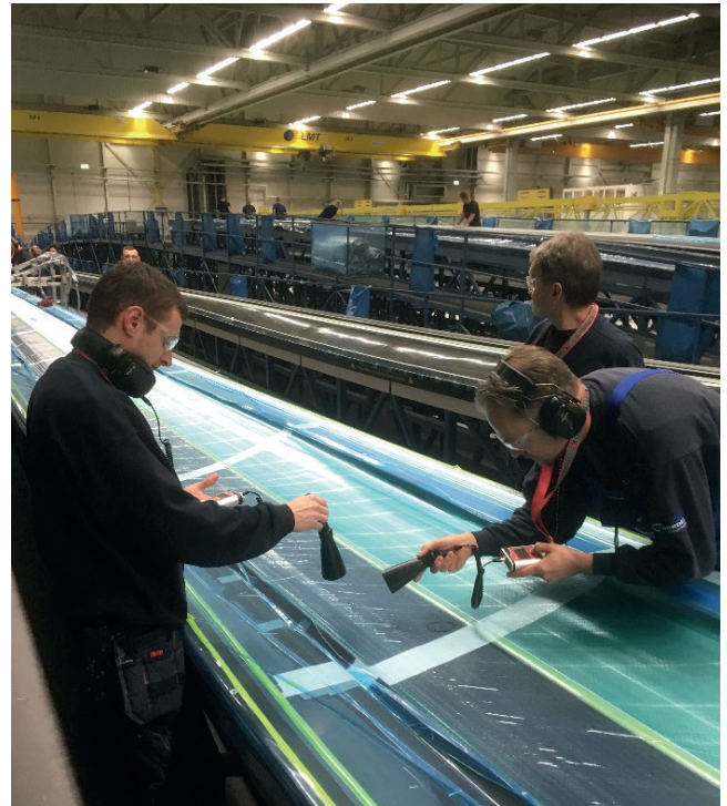
Abbildung 1: Leckageortung mittels Ultraschall-Prüftechnik während des Verfüllprozesses
